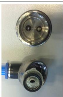
**Achtung :** Beim Aufsetzen des Entleerungsschlauchs auf das Ventilunterteil, achten Sie bitte auf die richtige Positionierung der Nocken des Ventilöffners, diese sind unterschiedlich groß und passen nur in einer Lage auf das Ventilunterteil
